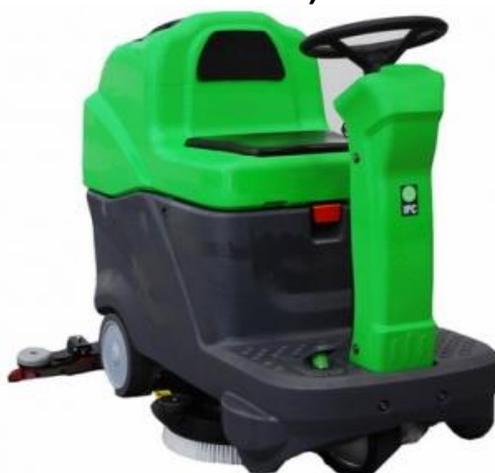
Аккумуляторная полумоечная машина IPC Gansow CT 80 BT 55 - компактная полумоечная машина с сиденьем для оператора для уборки помещений средней площади. Большая вместимость баков (80/85 л) при минимальных внешних габаритах. Ее главное преимущество - компактность, это позволяет заменить обычную толкаемую машину на более удобную с сиденьем для оператора. Модель отлично справится с чисткой любой сложности, делая работу быстро и качественно.
